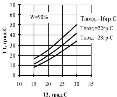
Рис.6. Графики охлаждения при расходе воды 30 м<sup>3</sup>/ч:
